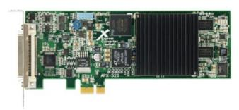
APX-520 是 16 通道, 18 位分辨率的高速数据采集卡,采样周期最大 200KHz,基于 PCI Express 接口的高速数据采集卡,具有 4 个分辨率为 16 位的 DA 输出和 4 个通用 DIO 输入/输出通道。
