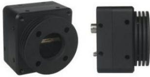
FS-B2KU7CL 线阵工业相机，采用黑白高速 CMOS 图像传感器，分辨率 2K，行频达 80kHz，具有高分辨率、高速度、外观紧凑等特点。相机通过 Camera Link 接口输出，可选配 F-Mount 镜头适配器，具有抗晕设计和平场校正功能，安装和使用极为方便。
