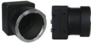
FS-C4KU7DCL 彩色线阵工业相机, 采用 Bayer 彩色高速 CMOS 图像传感器, 双线扫描方式, 分辨率 4K, 行频达 80KHz。该相机具有高分辨率、高速度、外观紧凑等特点, Base Camera Link 接口输出, 具有抗晕设计和平场校正功能, 安装和使用极为方便。
