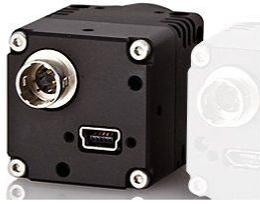
STC-MB33USB 黑白工业相机是一款 30 万像素的 MiniUSB 高速工业相机，具有硬件触发采集功能。该工业相机采用 1/3 英寸高灵敏度 CCD 图像传感器，具有感光效果好，图像质量高的特点。是一款外观精巧，外形尺寸小，重量轻，刚性高，价格合理的工业相机，相机四面均设计有安装孔，安装非常方便。
