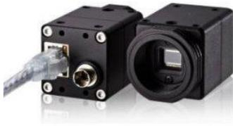
STC-SCS241POE 彩色工业相机是一款 230 万像素的高速工业相机，采用日本索尼 IMX174 彩色图像传感器，分辨率为 1920×1200，拍摄速度达 45fps，全帧曝光方式，具有硬件触发功能，秉承了 Sentech PoE 工业相机的小外形、安装灵活、使用方便的特色，此款高速工业相机在高速成像或其它高速运动物体抓拍应用上能挥其良好的性能。
