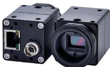
STC-SCS853POE 彩色工业相机是一款 830 万像素的高分辨率千兆网相机，采用 1/2.5 英寸 Sony IMX274 彩色图像传感器，分辨率为 3840×2160，拍摄速度达 12.7fps，滚动快门，具有硬件触发功能，可 POE 供电，秉承了 Sentech PoE 工业相机的小外形、安装灵活、使用方便的特色。
