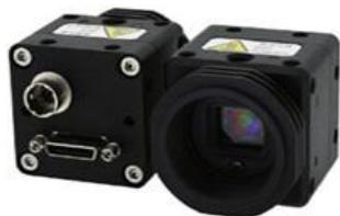
STC-SPB500PCL 黑白工业相机是日本 Sentech 生产的 500 万像素高分辨率工业相机，采用 2/3 英寸 Sony IMX264 CMOS 图像传感器，分辨率 2448 × 2048，全分辨率下帧率高达 35.7 帧/秒。Sentech Camera Link 系列 CMOS 相机体积小、速度快、性价比高，具有 PoCL 功能，可直接通过 Camera Link 数据线缆给相机供电。
