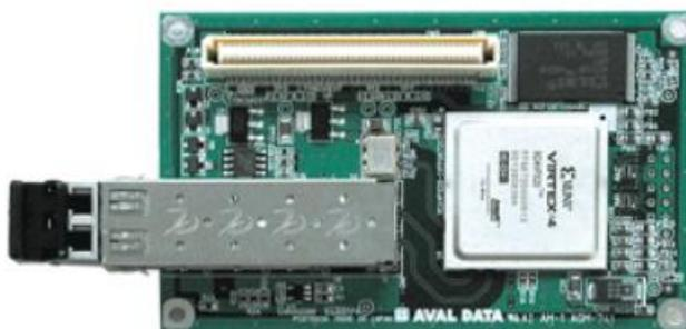
AGM-741A 是一个卡片式的 GIGA CHANNEL，可以实现客户设备中数据的 4.25Gbps 高速串行通信。AGM-741A 使用光缆与设备连接，与设备的连接是一个类似存储器的接口，因此很容易实现。由于通信协议处理是在硬件中进行的，因此不需要特殊处理。
