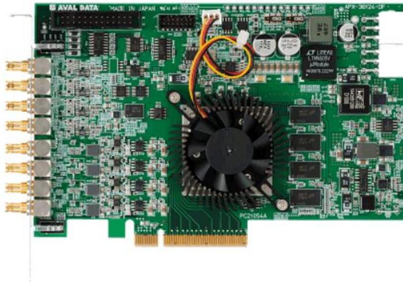
APX-36124-DF 是由日本 AVAL DATA 公司制造的符合 CoaXPress 2.0 规范、支持 CXP-12 Quad 1Ch , Dual 1Ch, Single 1Ch 的多通道高速采集卡，最高传输速度可达 50G/s，可在 PC 上快速获取图像板载配备 DDR4 SDRAM 4GB，可用作 FIFO 存储器或工作存储器。
