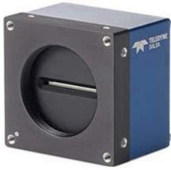
P4-CC-02K04T 是 Teledyne DALSA 公司推出的一款 Piranha4 系列三线扫描彩色线阵相机，采用 DALSA 高性能 CMOS 三原色传感器，通过最小空间间距，实现最大程度的色彩精度和性能。分辨率 2048×3，行频高达 40kHz，Camera Link 数据接口，线缆长度可达到 30 米及以上。GenICam™ 兼容接口，便于相机的安装、控制和集成。
