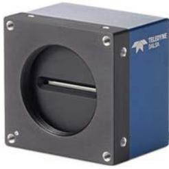
P4-CC-04K07T 是 Teledyne DALSA 公司推出的一款 Piranha4 系列三线扫描彩色线阵相机，采用 DALSA 高性能 CMOS 三原色（红、绿、蓝）传感器，通过最小空间间距，实现最大程度的色彩精度和性能。分辨率 4096×3，行频 70kHz，Camera Link 数据接口。GenICam™ 兼容接口，便于相机的安装、控制和集成。
