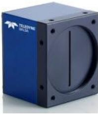
SG-14-04K80 黑白线阵工业相机是 Teledyne DALSA 公司推出的最新一代千兆网工业线阵相机，不再需要采集卡，一定程度上节约了系统成本，并可实现长距离传输。相对 Spyder 2 系列产品而言，Spyder 3 采用了双线扫描技术，具有高达 3 倍的响应度和 2 倍的速度。可通过编程精确地控制一些关键的操作，如增益和偏移等。
