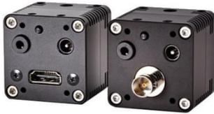
STC-HD93DV-CS 是一款 720P 高清彩色 CCD 工业相机,可直接通过 HDMI 线缆连接显示器或电视机,无需连接 PC 就可看到图像。该工业相机支持有菜单控制按键进行参数设置,如使用另配的控制盒,画面上可以显示十字线和 shadow mask。Sentech HD 高清工业相机采用紧凑型外形设计,并提供板级产品供用户选择。
